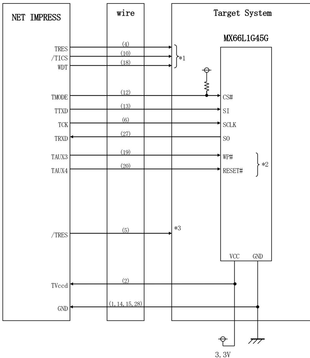
図 3-2 ターゲットシステムとの接続例
