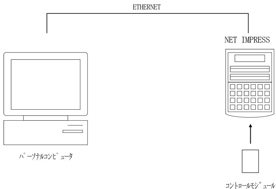
パーソナルコンピュータ (IBM-PC) と NET IMPRESS を ETHERNET ケーブル (10BASE-T) で接続します。
