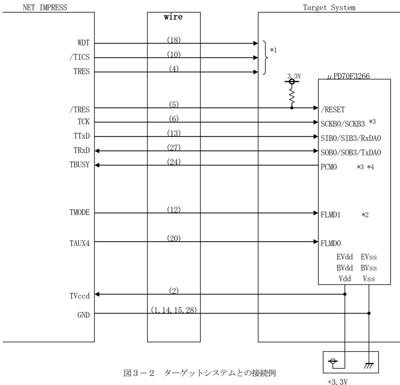
図3-2 ターゲットシステムとの接続例
