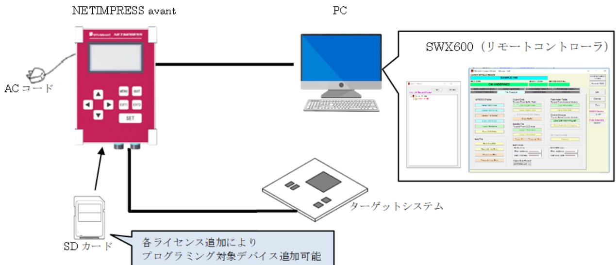
本機に挿入する専用 SD カード内に、各種マイコンのプログラミング用のファームデータ（定義体）を追加することにより、各種デバイス（ECU）に対応することができます。
